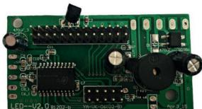
Плата управления состоит из текстолита, является составляющей частью для ВТН-100. Представляет из себя печатную электронную плату. Микросхема состоит из трансформатора, конденсатора, транзисторов, предохранителей. Данная плата служит для регулировки работы оборудования. Регулировка происходит за счет увеличения емкости конденсаторов и понижения сопротивления. Рабочее напряжение – 220В.
