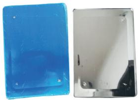
Представляет собой изделие в виде платформы прямоугольной формы, размерами 330x230x10 мм., с загнутыми краями по всему периметру изделия и с 3 ножками с изнаночной стороны (для установки и крепления платформы на весах). Платформа изготовлена из листа нержавеющей стали. Предназначена для помещения товаров и продуктов для их взвешивания.
