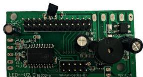
Плата управления состоит из текстолита, является составляющей частью для ВТН-1000. Представляет из себя печатную электронную плату. Микросхема состоит из трансформатора, конденсатора, транзисторов, предохранителей. Данная плата служит для регулировки работы оборудования. Регулировка происходит за счет увеличения емкости конденсаторов и понижения сопротивления. Рабочее напряжение – 220В.
